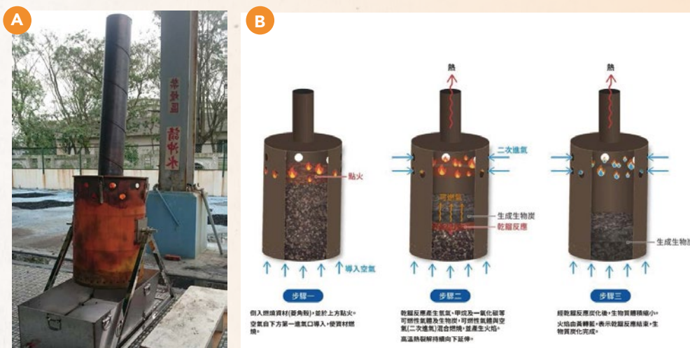
圖 1. (A)菱殼炭碳化爐照片 (B)上方點火法原理示意圖。
