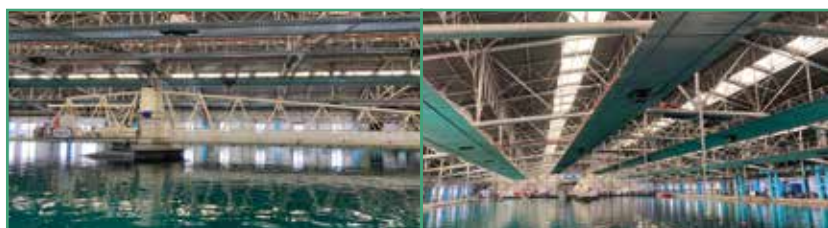
圖8、QinetiQ船舶運動及耐海性能水槽及其迴旋臂。
