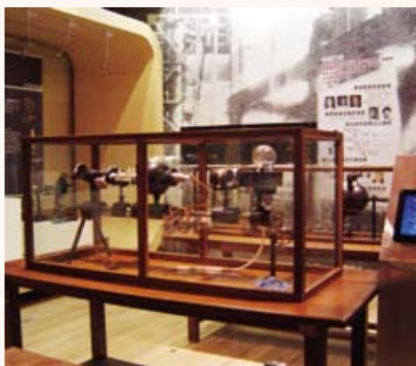
▲分析糖汁和油脂用的光度計與濁度計
