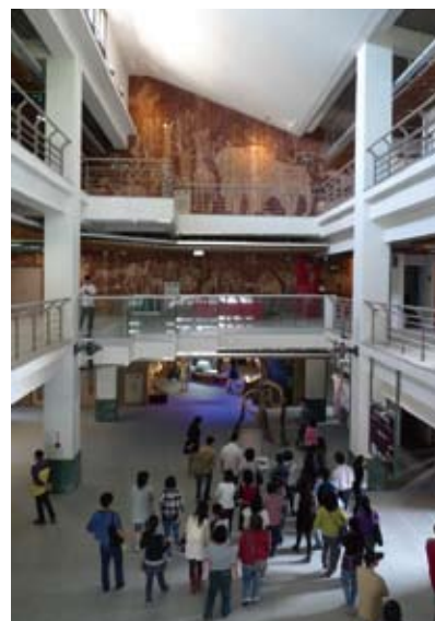
中庭的側牆自然採光與夜間陶瓷複金屬燈照明，採用天花板擴散反射方式，光線柔美、氣氛優美。
